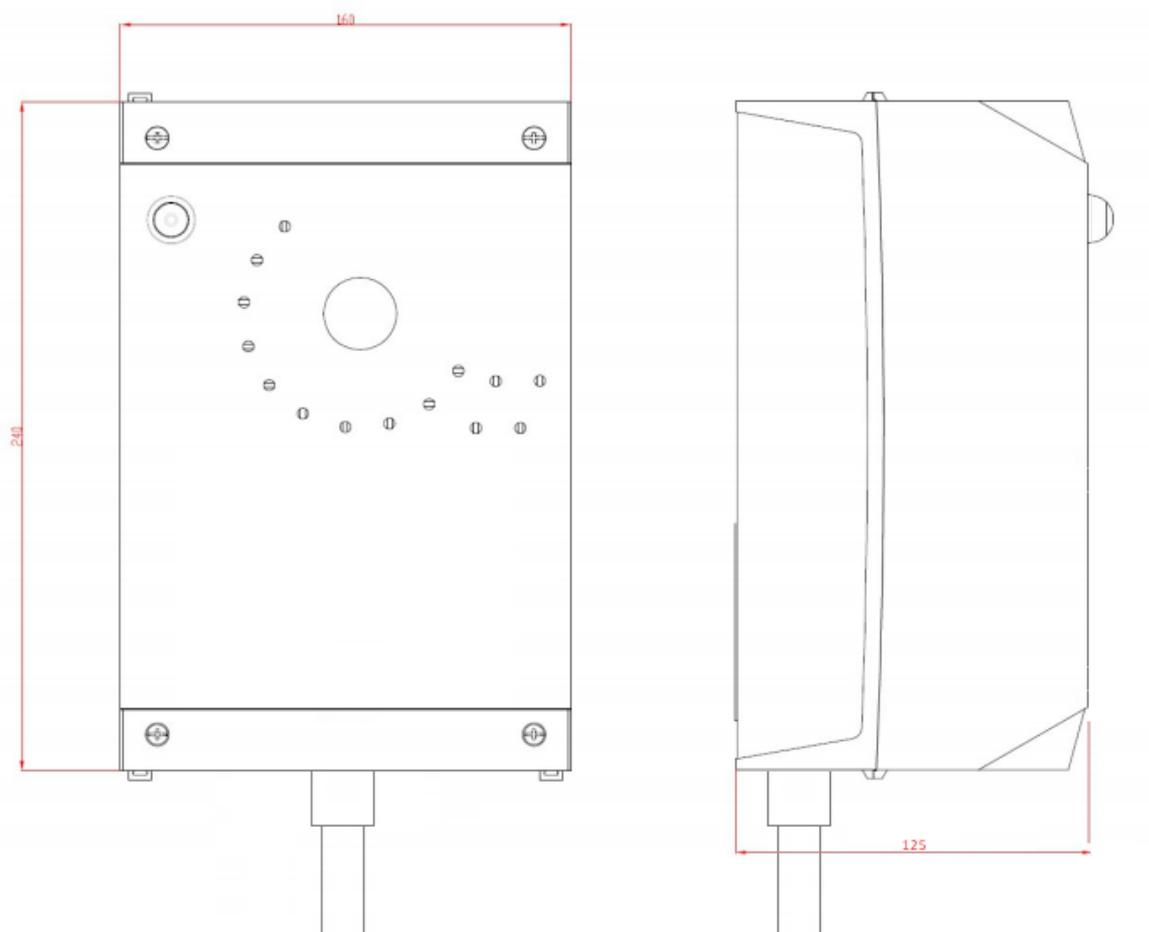
Tramite quattro fori raggiungibili dall'interno è possibile il fissaggio a parete del box.
